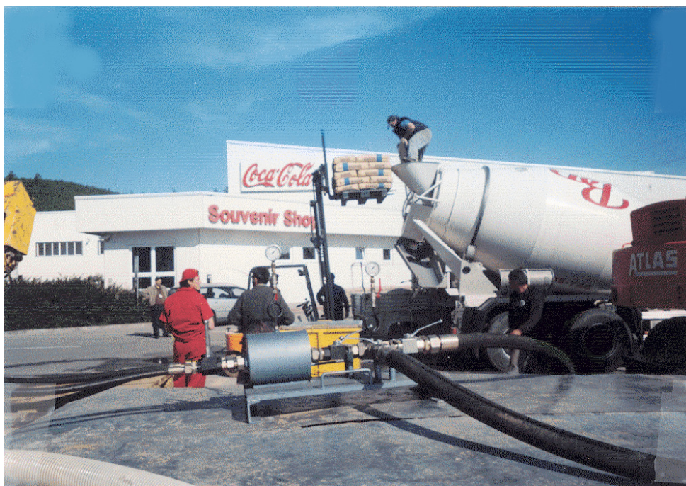
Slika 4. Oprema za cementaciju (F. Skopljak 2004) Figure 4 Cementing equipment (F. Skopljak 2004)
