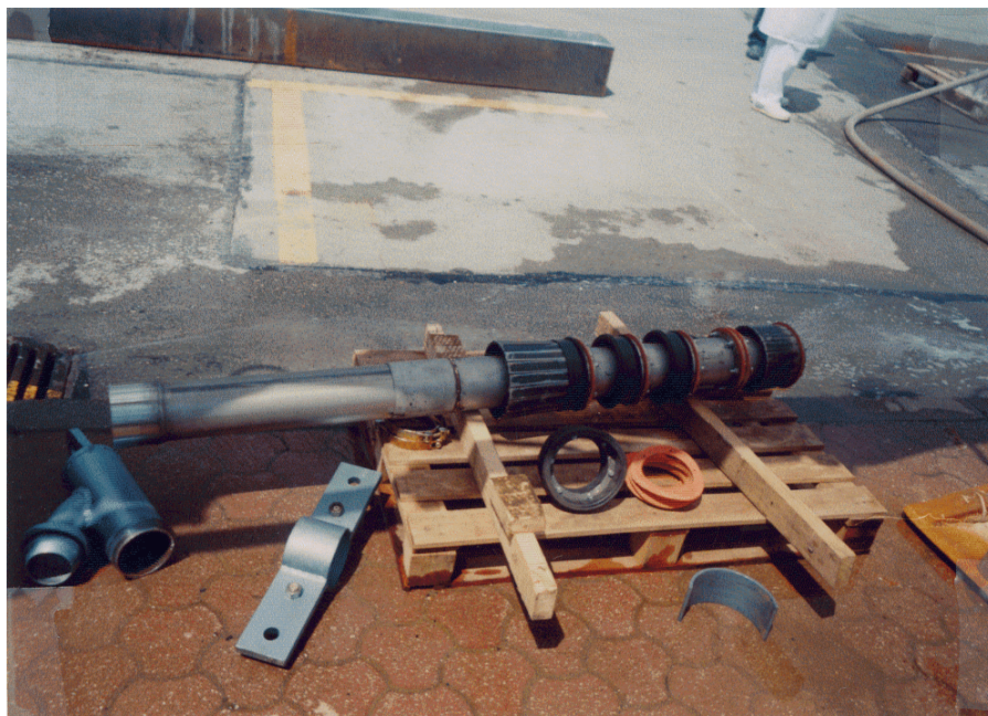
Slika 3. Paker (F. Skopljak 2004) Figure 3 Packer (F. Skopljak 2004)
