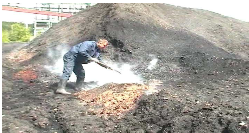
Slika 10. Razgrtanje užarenog uglja radi kvašenja rastvorom „PX“ Figure 10. Excavation midst of coal for wetting solution "PX"
