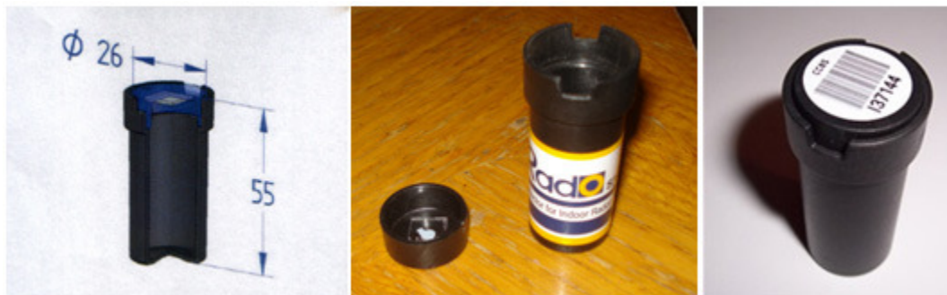
Slika 1. Difuzijska komora PADC/CR-39 detektora Figure 1. Diffusion chamber detector PADC/CR-39
